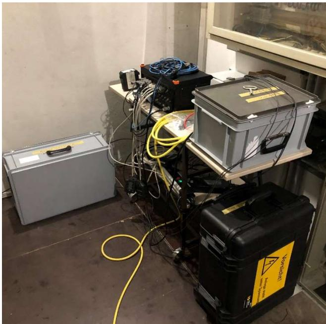
Neues Messgerät zur Erfassung der Oberschwingungen für Strom und Spannung bis 150kHz und bis zu 16 zeitgleich erfassbar Messeingänge.
