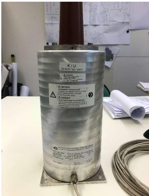
Bild 4: Spannungswandler der Fa. ALTEA 1 Phase luftisoliert
