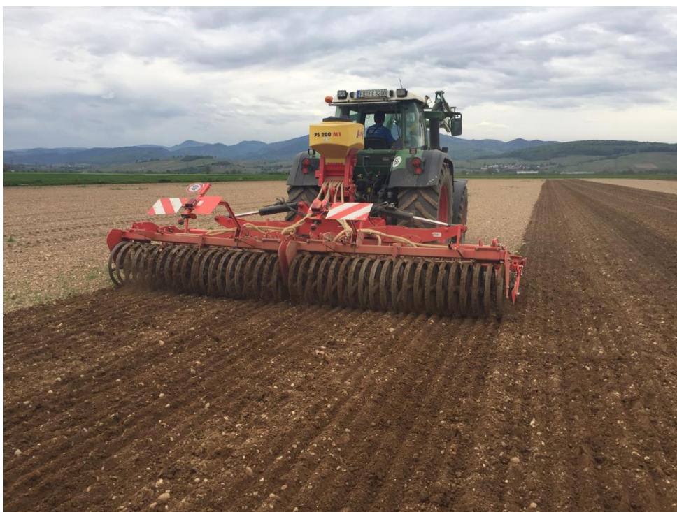
Einarbeitung des Stockosorb-Granulates mit Granulator und Scheibenegge nach Hirse vor Triticale (September 2017):
