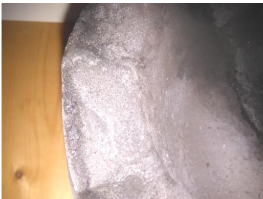
Abbildung 4 Detailansicht abgebrannter Kolben
