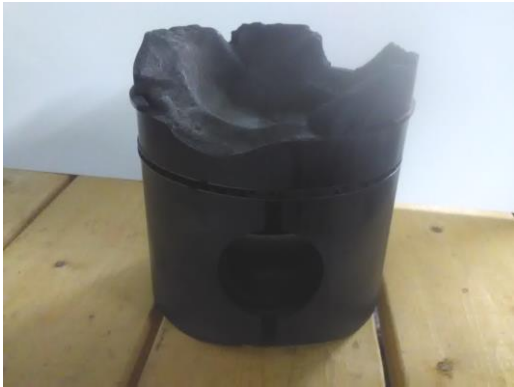
Abbildung 3 Abgebrannter Kolben durch zu hohe Zündenergie
