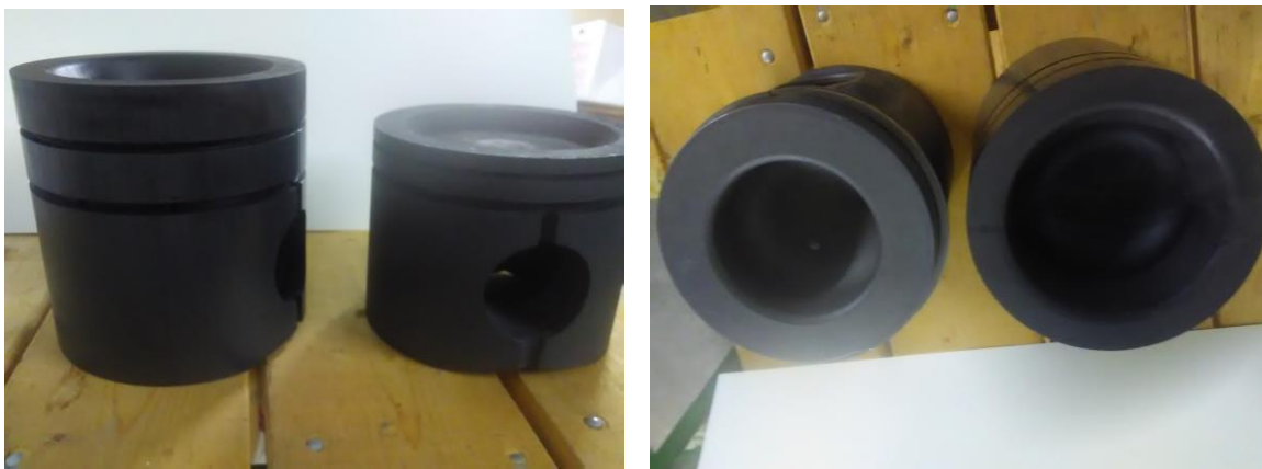
Abbildung 1 Kolben der kompressionsmessung, sowie original und Graphitkolben
