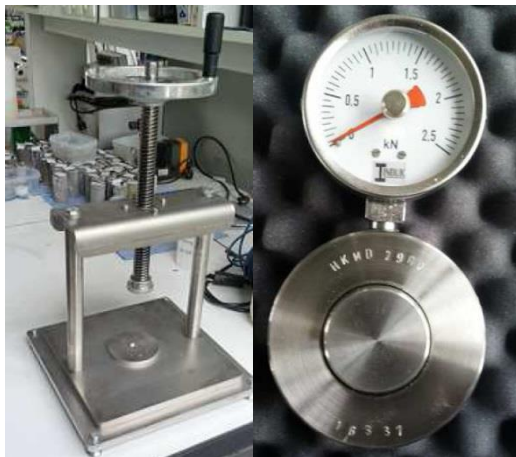
Abbildung 5: Spindelpresse und hydraulischer Kraftaufnehmer für die Ermittlung der Druckfestigkeiten
