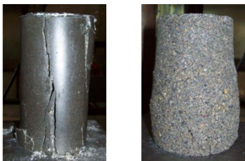
Abbildung 11: Polymerbetonprobe nach der Druckprüfung (links: mit Epoxidharz; rechts mit Polyesterharz)
