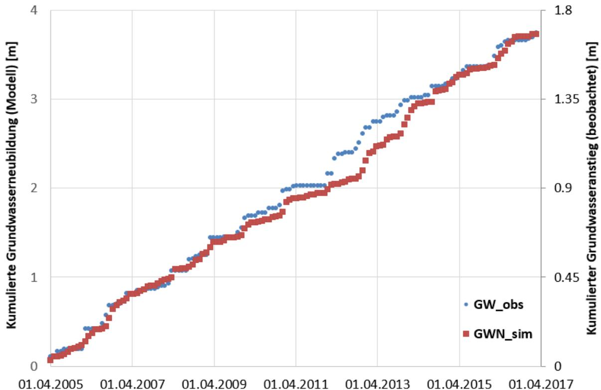
Abbildung 28: Beobachtete aufsummierte (positive) Grundwasserstandsänderungen der Grundwassermessstelle GW\_MSt\_2176\_069\_08 im Vergleich zur simulierten aufsummierten mittleren Grundwasserneubildung des Vergleichsbereichs im Stadtteil Landwasser (Lage siehe Abbildung 1)
