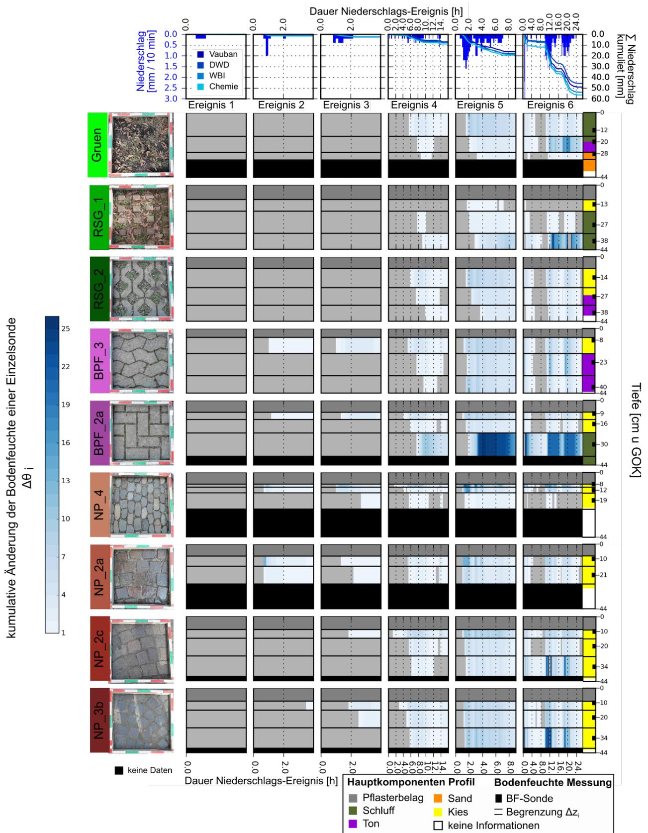
Abbildung 19: Beispielhafter Darstellung der Dynamik des Bodenwasserhaushalts unter ausgewählten urbanen Oberflächen. Die Intensität der Blaufärbung gibt die Stärke der Änderung im Bodenwasserhaushalt an. Im oberen Bereich der Abbildung sind typische Niederschlagsereignisse aus dem Beobachtungszeitraum abgebildet. Verändert nach (Schaffitel et al. 2017).
