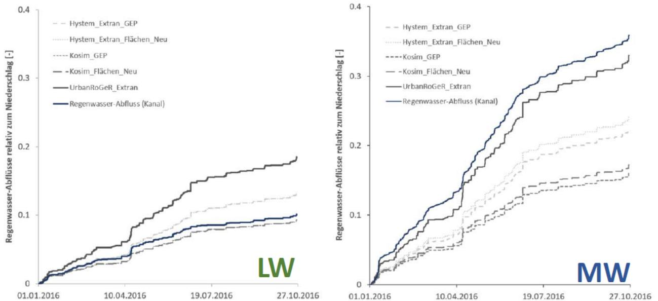
Abbildung 27: Beobachteter Regenwasseranfall in der Kanalisation und simulierter Niederschlags-Abfluss für die Stadtteile Mooswald (MW) und Landwasser (LW) kumulativ für das Jahr 2016.
