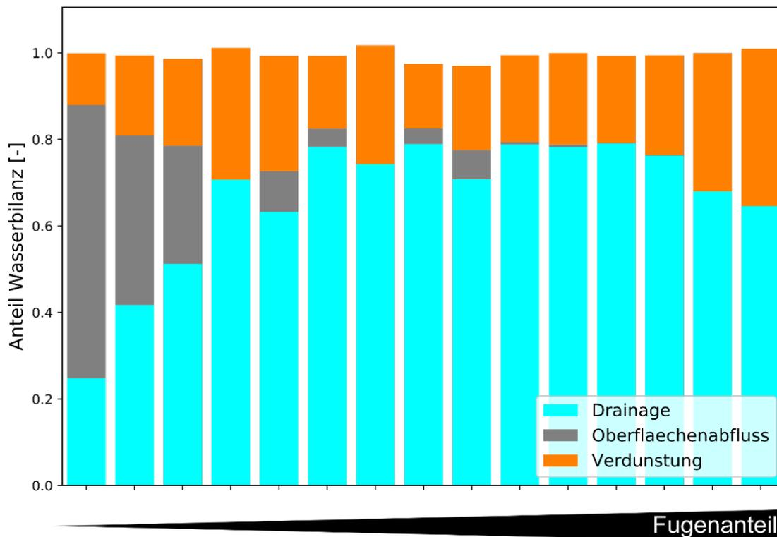
Abbildung 21: Bodenwasserbilanz von 15 gepflasterten Oberflächen über den gesamten Messzeitraum berechnet mittels Daten-basiertem Modellansatz. Der Fugenanteil der Flächen nimmt von links (gefügedichtetes Rechteckpflaster) nach rechts (Rasengittersteine) kontinuierlich zu.
