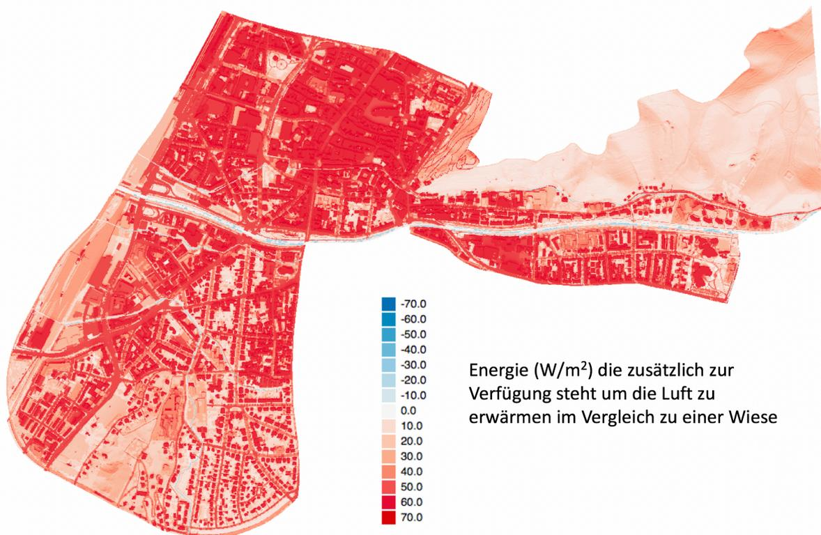
Abbildung 35: Energiemenge die durch fehlende Verdunstung im Vergleich zu einer bewässerten Grasfläche vorhanden ist um die Luft zu erwärmen für die Stadtteile Altstadt, Oberau und Unterwiehre.
