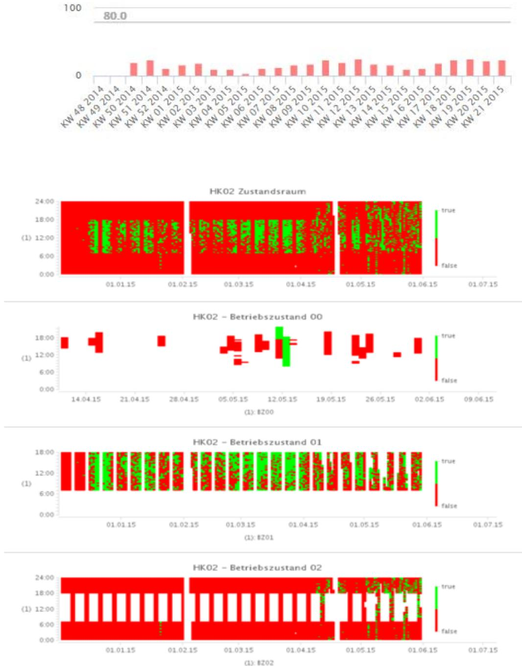
Abbildung 41 Visualisierung der Auswertung einer Aktiven Funktionsbeschreibung
