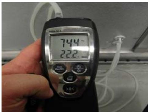
Abbildung 59 Volumenstrom Differenzdruckverfahren
