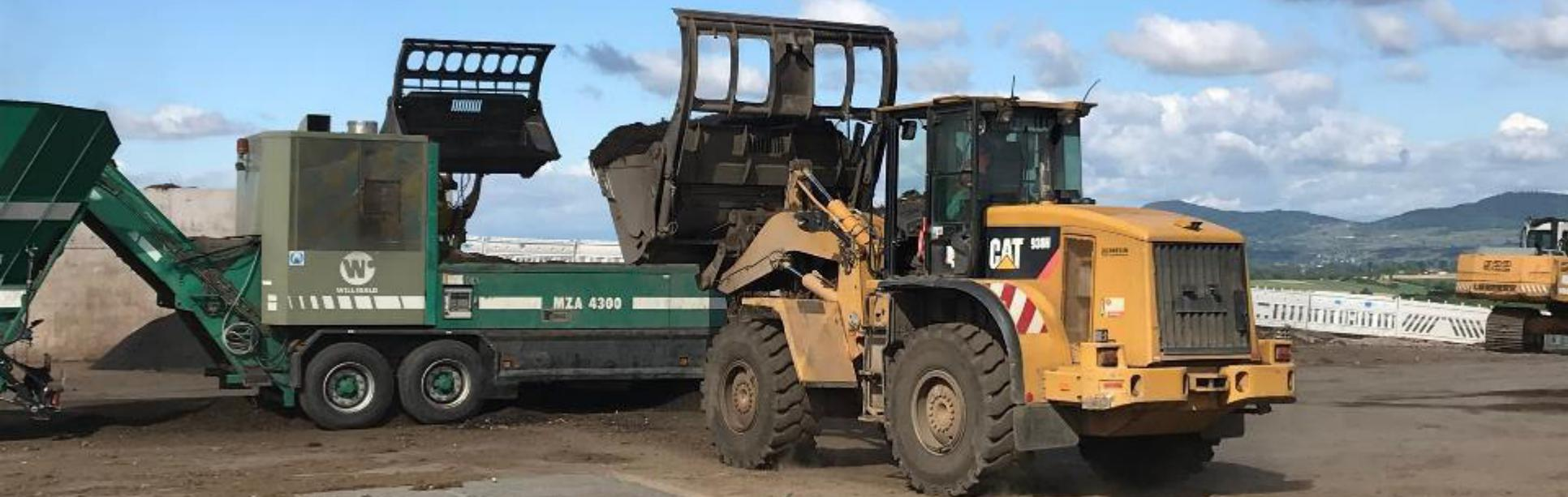
volumetrisches Mischen von vor-zerkleinertem Grüngut (rechts) und Pflanzenkohle (links) in den Shredder
