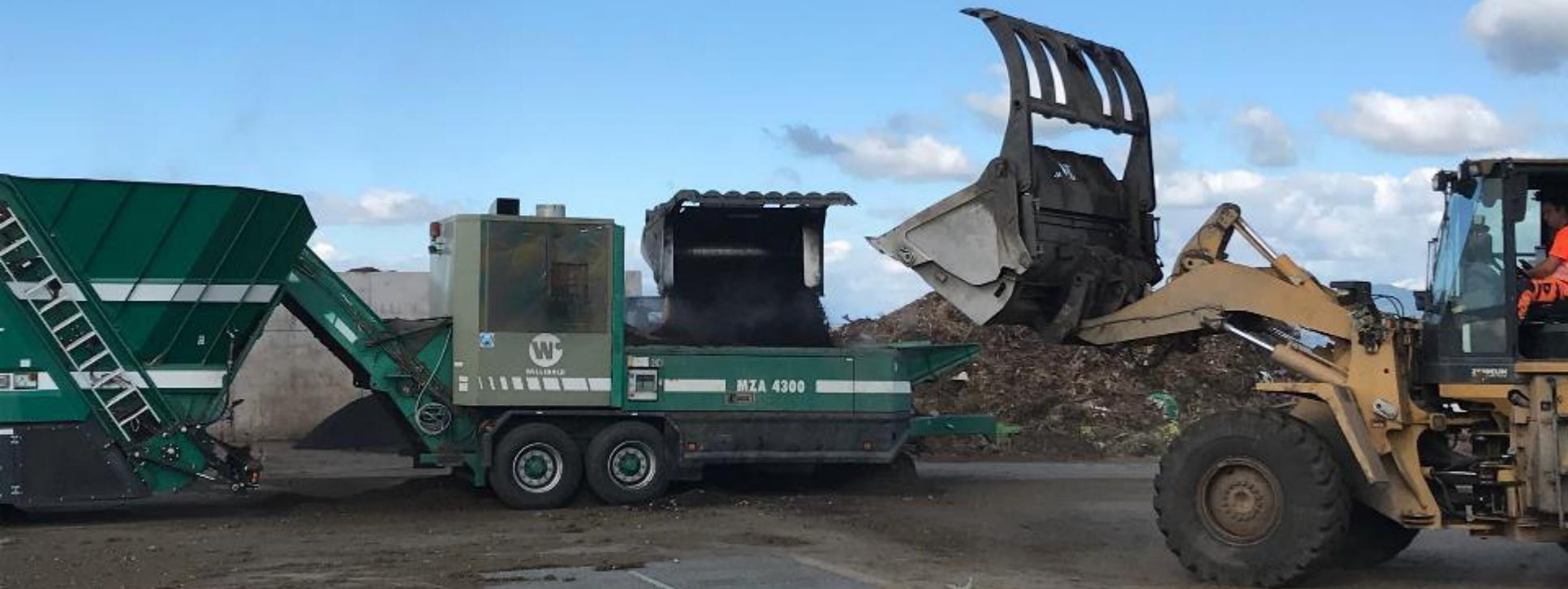
weitgehend staubfreies Schütten der Pflanzenkohle, Pflanzenkohle wurde nach der Pyrolyse ausreichend befeuchtet.
