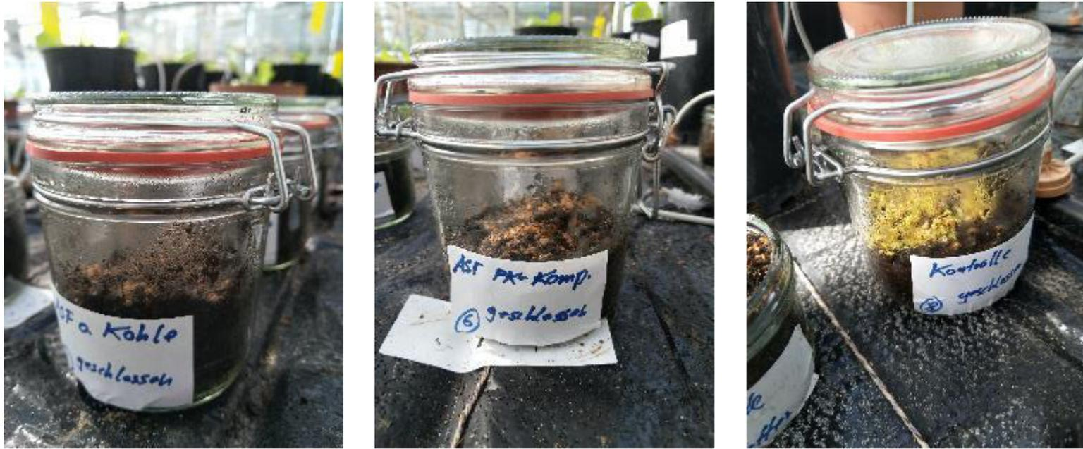
Abb: Geschlossener Kressetest mit ASF-Kontrollkompost ohne Pflanzenkohle (li), ASF Pflanzenkohle-Kompost (mi) und einem kommerziellen Gewächshaussubstrat („Kontrolle“) (re) nach 5 Tagen.
