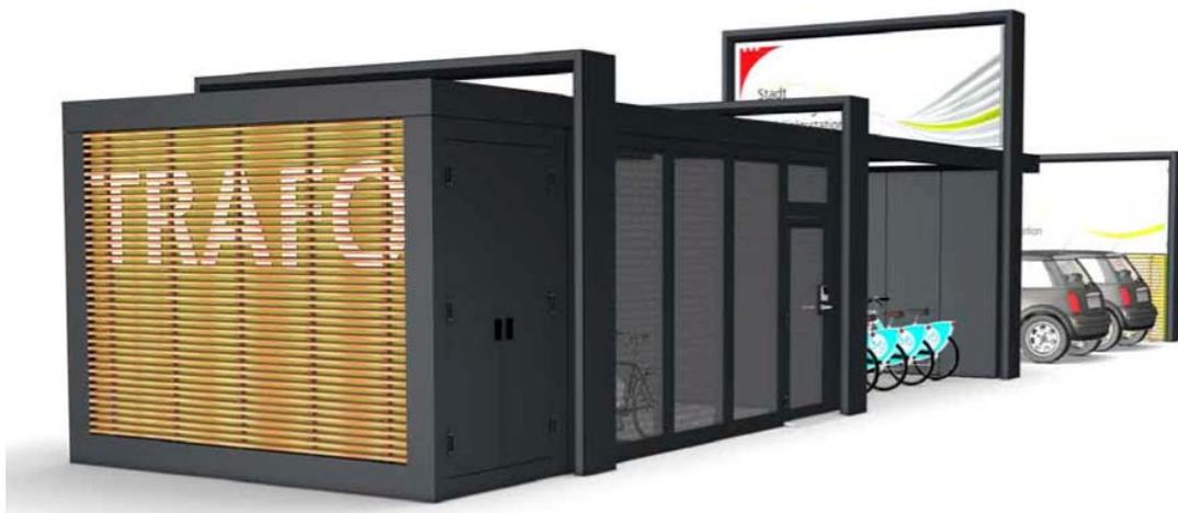
Abbildung 4: Modulelement für Trafostation; André Stocker Design
