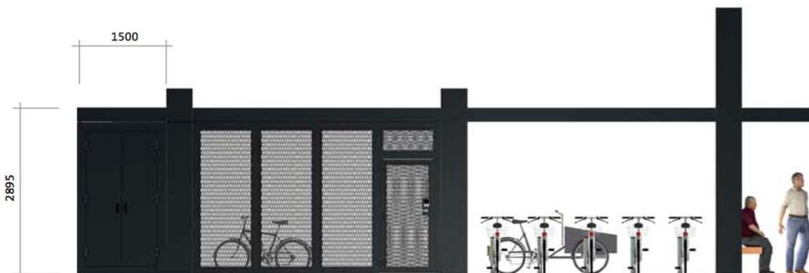
Abbildung 5: Modulelement für Trafostation; André Stocker Design
