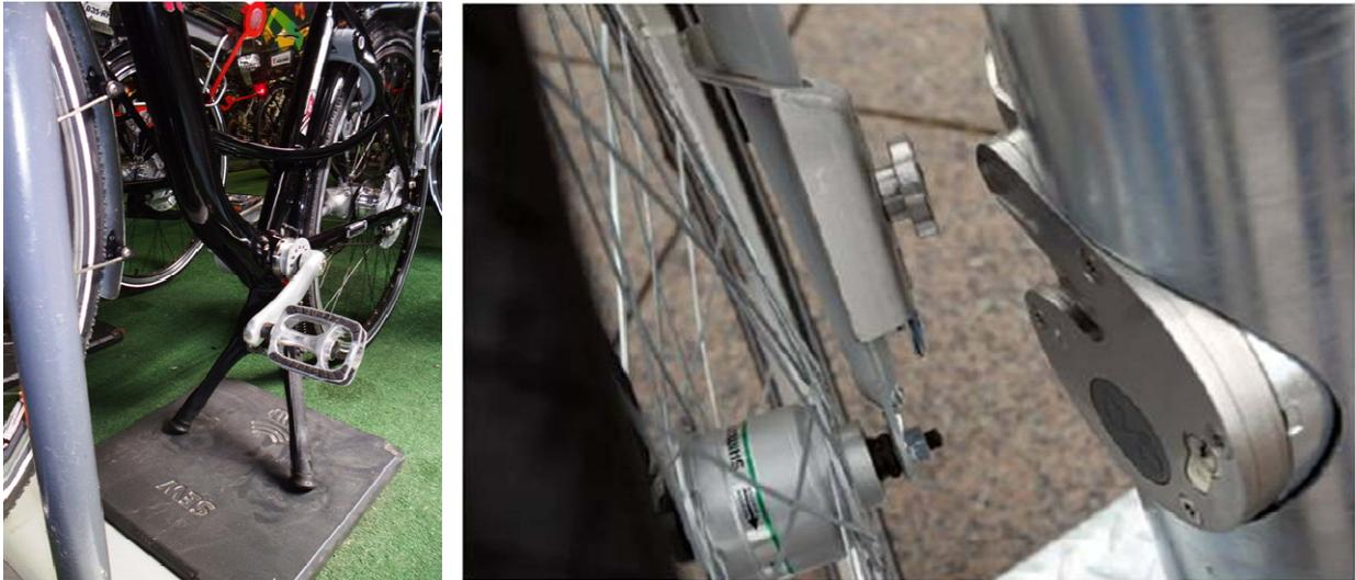
Abb. 11: Mögliche induktive Ladetechniken (links: Ladung über Ständer, rechts: Ladung über Vorderradgabel)
