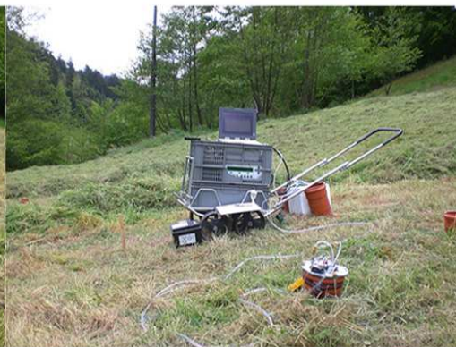
Bild 25: Vielfachgasmonitor für Feldmessungen präpariert
