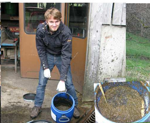
Bilder 6/7: Ansetzen der Gülle-Kohlemischungen in Fässern Februar 2014
