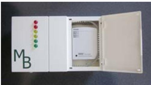
Abb. 2.6: CO<sub>2</sub>-Ampel mit Hobo-Datenlogger (Foto MB-Systemtechnik)
