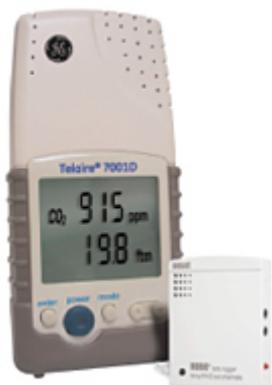
Abb. 3.2: Messaufbau zur Erfassung von Raumtemperatur, relativer Feuchte und CO<sub>2</sub>-Konzentration. Rechts der HOBO-Datenlogger mit integrierten Temperatur- und Feuchtesensoren. Links der Telaire 7001-Sensor mit Display mit dem die CO<sub>2</sub>-Konzentration erfasst wird.
