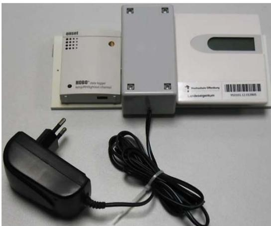
Abb. 3.1: Messaufbau zur Erfassung von Raumtemperatur, relativer Feuchte und CO<sub>2</sub>-Konzentration. Links der HOBO-Datenlogger mit integrierten Temperatur- und Feuchtesensoren. Rechts der E+E E80-Sensor mit dem die CO<sub>2</sub>-Konzentration erfasst wird, mit Display.
