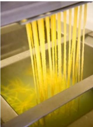
**Abbildung 1: Druckwasser beheiztes Kochbad zur Spätzle und Maultaschenproduktion**
