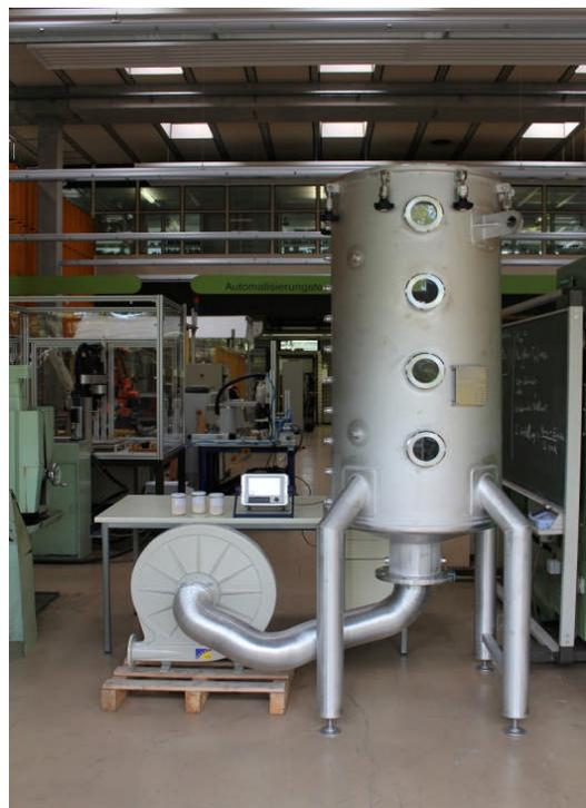
Abbildung 15: Versuchsbehälter für Zeolithspeicher
