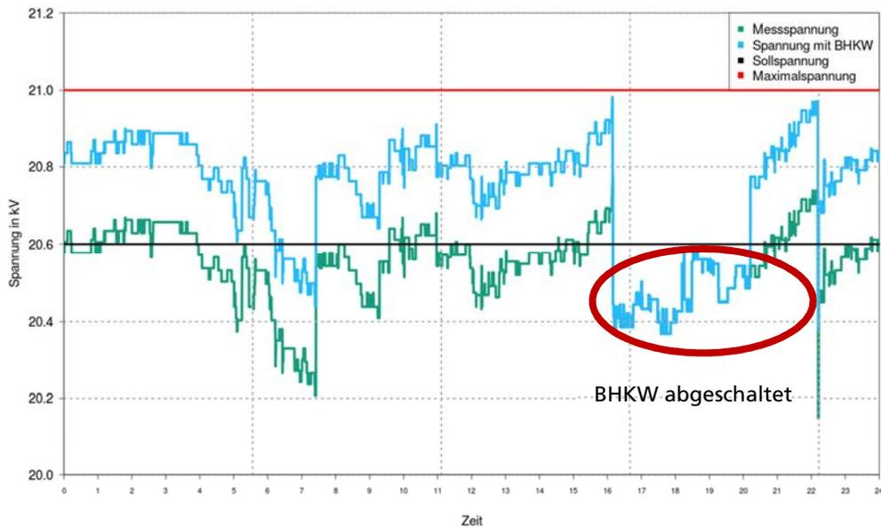
Abbildung 26: Spannungsverlauf am Eichelbuck mit spannungsgeregeltem BHKW.
