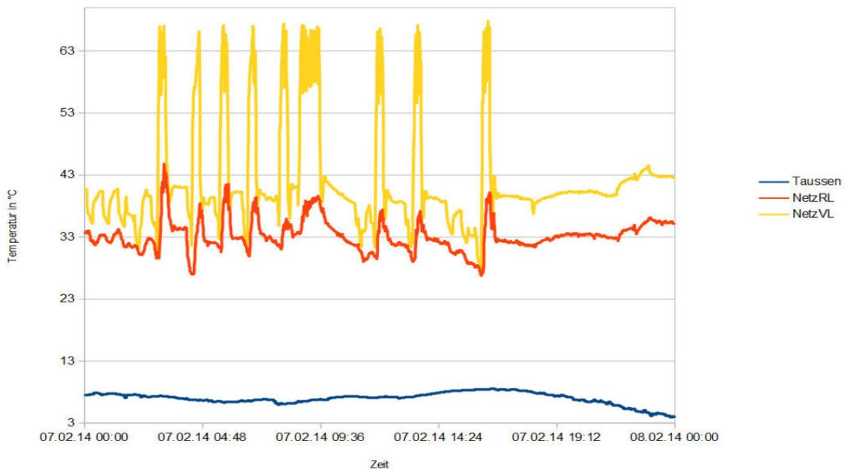
Grafik 5.2.2 Temperaturverläufe Heizkreislauf und Umgebungstemperatur
