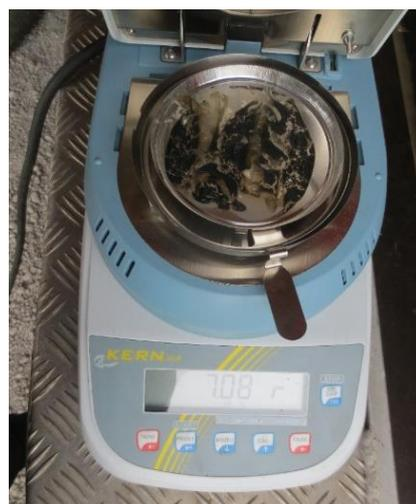
Abb. 47: Messgerät zur Feuchtebestimmung
