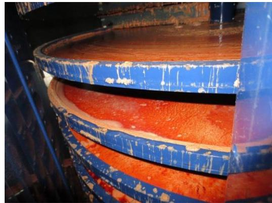
Abb. 35: Teller Trockner beim Einsatz mit Flotatschlamm aus der Kosmetik-Herstellung.
