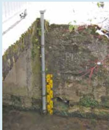
Kontinuierliche Messung des Wasserstandes des Vorfluters ca.100 m oberhalb der Einleitstelle des Trennsystems, zeitliche Auflösung: 10 min Messzeitraum: 5.1. 2010 – aktuell
