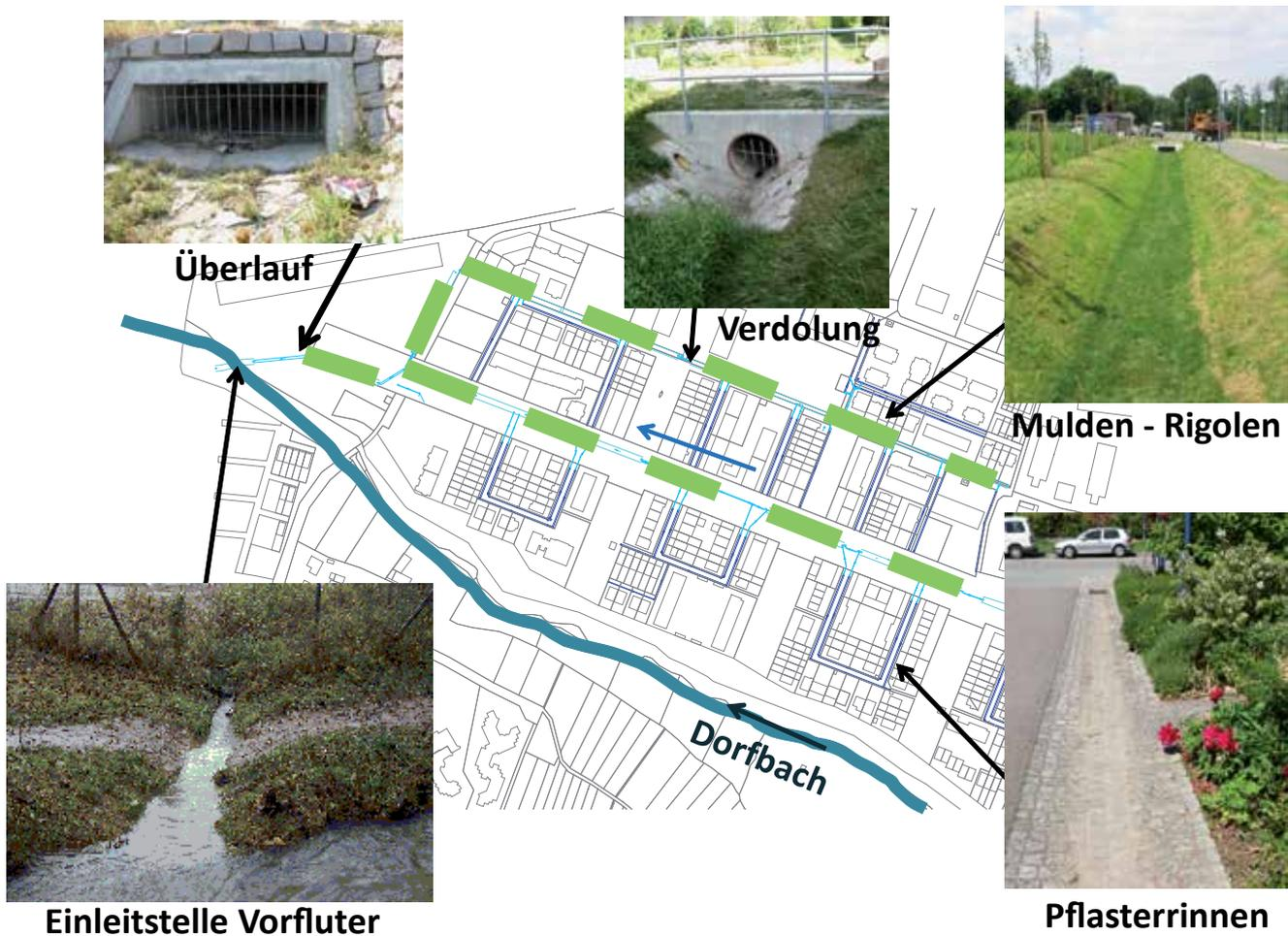
Abb.3 Elemente des zentralen Mulden-Rigolen-Systems.
