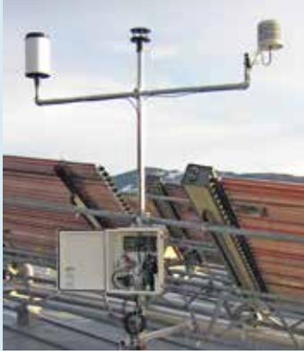
Kontinuierliche Messung Niederschlag, Lufttemperatur, Windrichtung und – geschwindigkeit, relative Luftfeuchte, Strahlungsintensität; zeitliche Auflösung: 1 min; Messzeitraum: 26.2.2010 – aktuell, Station online unter: <http://www.hydrology.uni-freiburg.de/vauban/wetterstation.html>
