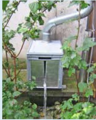
Kontinuierliche Messung Dachabfluss + Temperatur + Leitfähigkeit + Substratfeuchte an 4 verschiedenen Dachaufbauten (Kies, extensiv begrünt, intensiv begrünt, Eternit); zeitliche Auflösung: 1 min Messzeitraum: Mai 2010 – Nov. 2010, März 2011 – Sep. 2011
