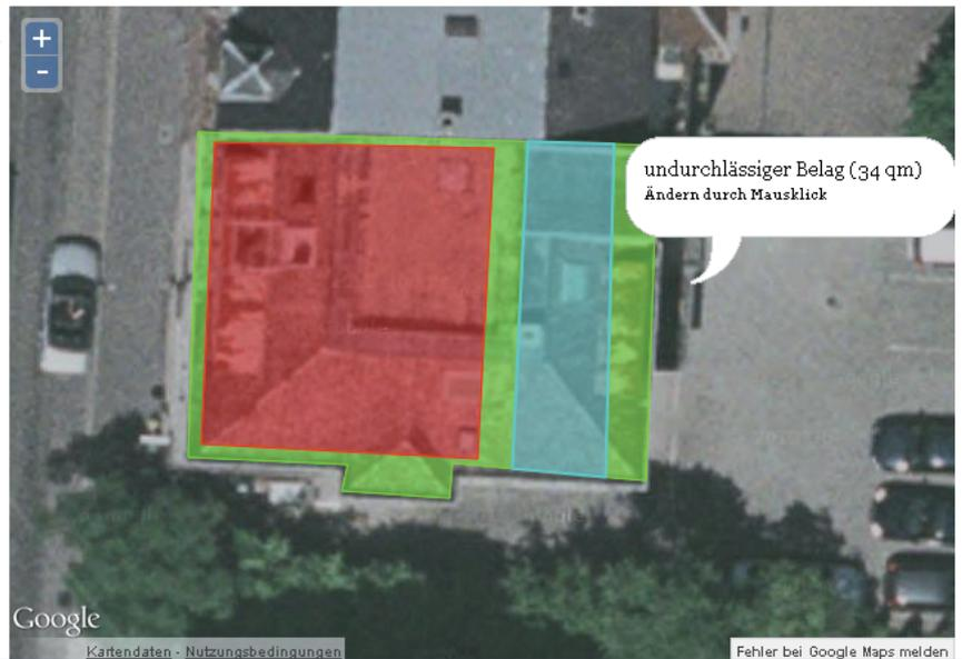
Abb. 48   Weboberflächen der neuen Webanwendung FReWaB zur Simulation der kleinräumigen Wasserbilanz und zu dezentraler Regenwasserbewirtschaftung.
