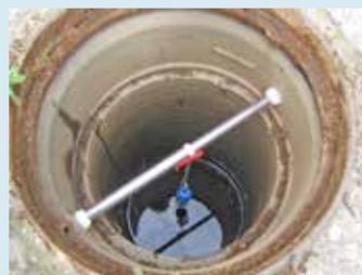
Kontinuierliche Messung von Wasserstand + Leitfähigkeit + Temperatur in 6 Rigolen in Rigolen-Kontrollschächten oder Mulden-Überlaufschächten, zeitliche Auflösung: 10 min; Messzeitraum: Juni 2010 – Okt./Dez. 2012
