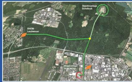
Unterirdische Gasleitungen transportieren das Gas täglich aus der Deponie Eichelbuck und – das ist neu – aus der Biogasanlage REMONDIS zum BHKW Landwasser, dafür wurde extra eine weitere, 1,5 km lange Gasleitung verlegt.
