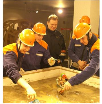
Dieses Modell entwickelte sich erwartungsgemäß zum Magneten der Ausstellung. Es wurde von kleineren und größeren Kindern ausgiebig bespielt. Das Wasser gelangte via eines Überlaufs in das Sandbecken und floss auf der gegenüberliegenden Seite über ein Fließ in einen Sandfang ab. Anschließend wurde es mit einer Pumpe unter dem Sandkasten wieder zum Einlauf transportiert.
