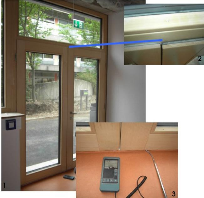
Fahrrad- und Theaterwerkstatt F104: Leckage an Übergang Boden/Türelement (Bild 3, 1,25 m/s) und Türdichtung oben (Bild 2, 0,8 m/s) in. Abhilfe durch Neueinstellung der Tür nach Ingebrauchnahme.
