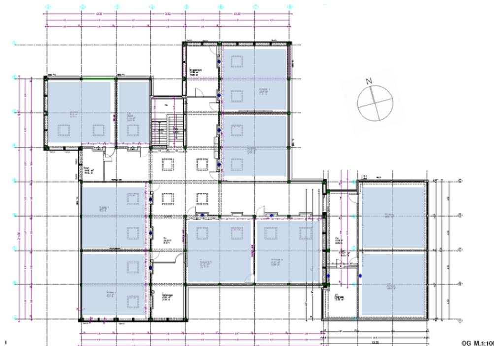
**Abbildung 3: Grundriss des 1. Obergeschoß. Eingefärbt sind die Klassenräume mit unterschiedlichen Querlüftungskonstellationen.**
