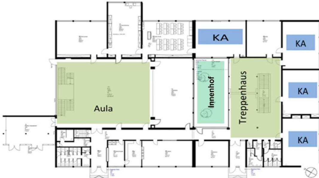
**Abbildung 2: Grundriss des Erdgeschoss im Fachklassentrakt des Oken-Gymnasiums. Gekennzeichnet sind die nordwestlich liegende Aula, das innen- liegende Treppenhaus, der begrünte Innenhof und die Klassenzimmer (KA) im Südosten.**
