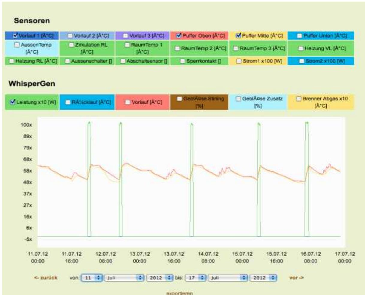
Abb. 59 Speichertemperaturen und Betrieb WhisperGen - 11. Jul. 2012 bis 17. Jul. 2012
