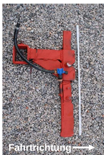
Abbildung 7: Injektionstechnik für Flüssigdünger bei Kartoffel an der Pflanzmaschine
