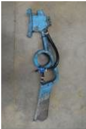
Abbildung 4: Injektionstechnik für Flüssigdünger bei Mais an der Sämaschine
