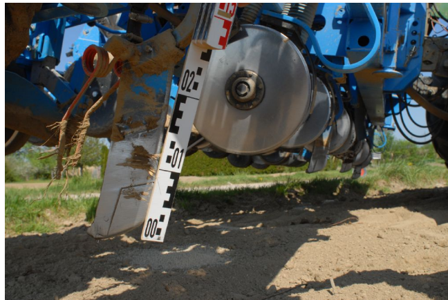
Abbildung 4: Injektionstechnik für Flüssigdünger bei Mais an der Sämaschine
