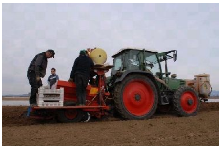
Abbildung 7: Injektionstechnik für Flüssigdünger bei Kartoffel an der Pflanzmaschine
