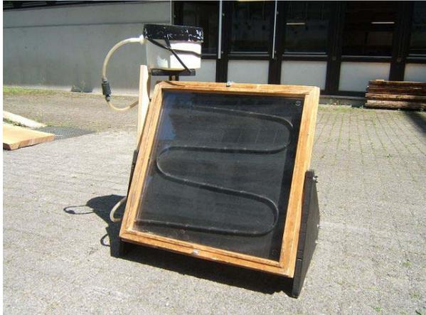
Abb. 7 Station 5 Solarkollektor
