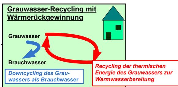
Abbildung 1: Schematische Darstellung der Kombination von stofflicher und energetischer Wiederverwertung des Grauwassers in der Pontos-Anlage
