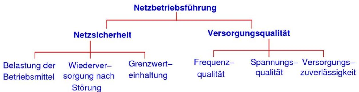
**Abbildung 3-1: Technische Aufgaben im Verteilnetzbetrieb, nach VDEW (2000)**
