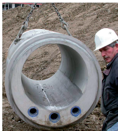
Abb. 17 Stehend hergestelltes Kanalrohr mit exzentrischer Schalung mit Monolithisch eingegossenem Wärmetauscherelement
