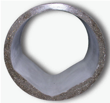
Abb. 31 Für nachträgliche Installation eines Wärmetauschers ungeeigneter moderner Rohrquerschnitt
