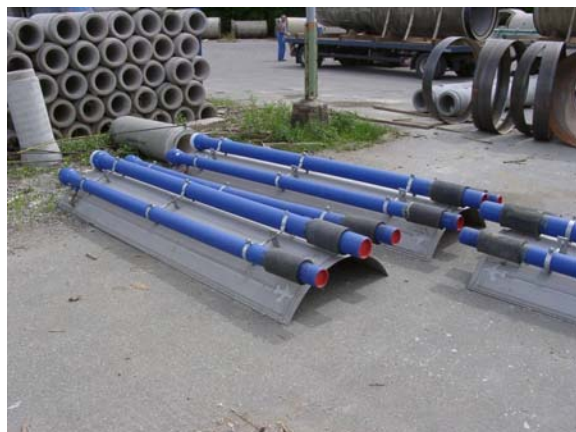
Abb. 2: Wärmetauscher vor Einbau und vorgefertigter Abwasserkanal mit Wärmetauscher
